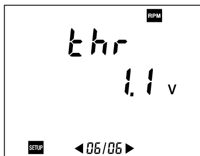
Figura 54: Visualizzazione del parametro relativo alla tensione di soglia del captore tachimetrico.
