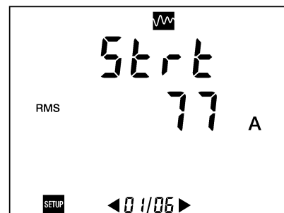
Figura 47: Visualizzazione del parametro relativo alla corrente di partenza.
