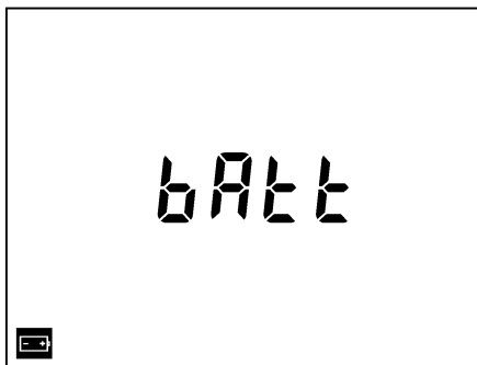
Figura 5: L'indicazione di batteria bassa che richiede una sostituzione.
