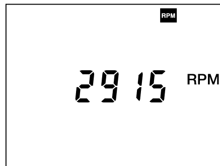
Figura 42: Esempio di una misurazione di velocità di rotazione.
