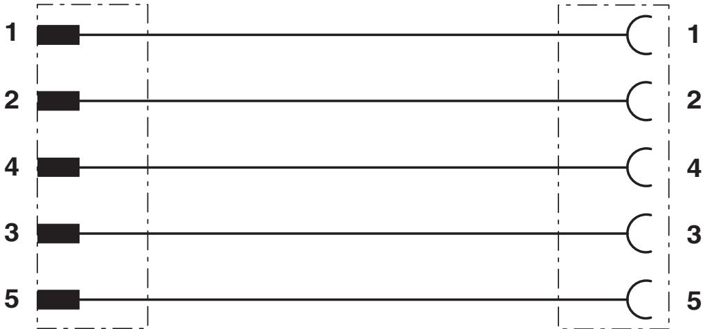
M12针式和M12孔式的触点分配
