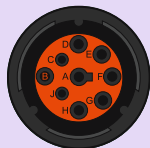
Pin assignment DEUTSCH Type 1
