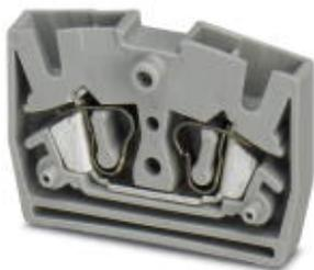
Mini-Durchgangsklemme, Anschlussart: Zugfederanschluss, Anzahl der Anschlüsse: 2, Querschnitt: 0,08 mm<sup>2</sup> - 4 mm<sup>2</sup>, AWG: 28 - 12, Breite: 5,2 mm, Höhe: 22 mm, Farbe: grau, Montageart: auf Montageplatte
