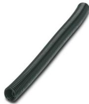
保护软管，标识材料: PA 6，抗紫外线: 是，柔性，保护等级: IP68，颜色: 黑色，阻燃等级符合UL 94: HB，内径: 6.5 mm，总长度: 50 m
