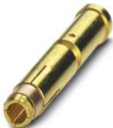
Crimpkontakt, gedreht, Kontaktdurchmesser: 2 mm, Crimpbereich: 0,25 mm<sup>2</sup> ... 1 mm<sup>2</sup>
