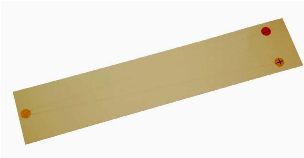
(L'illustration montre fine jauge thermocouple montée sur le morceau de carton d'emballage de protection pendant le transport)
