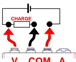
Le calcul de puissance **V x A** (VA) demande une 3<sup>ème</sup> connexion sur l'entrée A (reliée au même circuit) afin de mesurer simultanément :
