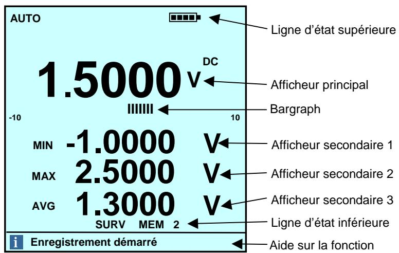
L'afficheur principal et le bargraph suivent en permanence l'évolution de la mesure.
