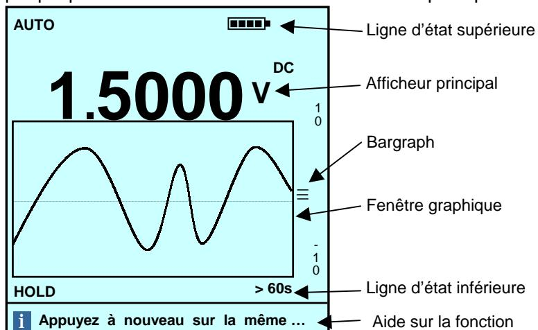
La fenêtre graphique et le bargraph suivent en permanence l'évolution de la mesure dans la gamme sélectionnée.
