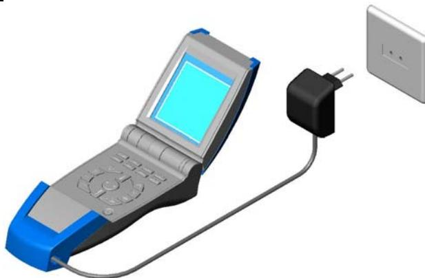
**Ne pas brancher le bloc alimentation lorsque des piles se trouvent dans l'appareil.**
