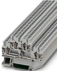
元件端子，带用于断路监控的10 kOhm电阻，第一和第二层，接线方式：回拉式弹簧连接，额定接线容量：2.5 mm<sup>2</sup>，接线容量：0.08 mm<sup>2</sup> - 4 mm<sup>2</sup>，安装：NS 35/7,5，NS 35/15，颜色：灰色
