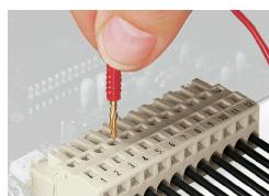
Test – Connecteur femelle avec CAGE CLAMP®, prise de test enfichable perpendiculairement à l'axe du conducteur, avec fiche de contrôle Ø 2 mm et Ø 2,3 mm
