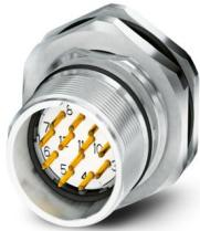
M23，设备连接器 板后安装，系列: CA，直头，屏蔽: 有，用于标准和SPEEDCON连锁，位数: 8+1，旋转方向: 标准，触点类型: 针式插头，焊接，轴向密封，编码: N，根据RoHS II指令（不含豁免条款6c，即铅含量<0.1%），本产品预计自2027年第一季度起实现无铅化；如需提前获得无铅替代品，可应要求提供
