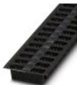
Connecteur mâle, intensité nominale: 8 A, tension assignée (III/2): 250 V, nombre de pôles: 8, pas: 3,5 mm, coloris: noir, surface des contacts: étain, montage: Soudage THR, L'intensité maximale est fonction du connecteur utilisé. La plus petite des deux valeurs d'intensité pour le connecteur et l'embase mâles est déterminante. Le connecteur mâle est en plastique résistant à de hautes températures et convient donc au processus de refusion.
