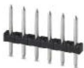
Connecteur mâle, intensité nominale: 8 A, tension assignée (III/2): 250 V, nombre de pôles: 8, pas: 3,5 mm, coloris: noir, surface des contacts: étain, montage: Soudage THR, L'intensité maximale est fonction du connecteur utilisé. La plus petite des deux valeurs d'intensité pour le connecteur et l'embase mâles est déterminante. Le connecteur mâle est en plastique résistant à de hautes températures et convient donc au processus de refusion.
