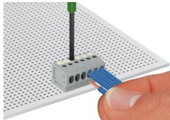
Raccordement des conducteurs rigides par insertion directe.
