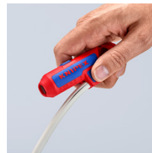
Met verborgen mes in een aan de zijkant uitkragend duimpad voor een comfortabele langssnede
