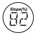
**Problem** – Im Laufe der Zeit wird der Sensorteil des Glases langsamer ansprechen und später ganz versagen. Auch sind Schäden durch den Gebrauch möglich. Dies führt zu falschen Messwerten.
