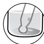
**Problem** – Sensorglas und Diaphragma müssen vollständig in die Probe eingetaucht sein um korrekt funktionieren zu können.
