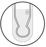
**Problem** – Eine Aufbewahrung in entionisiertem oder destilliertem Wasser führt zu einer trägen Reaktion weil Ionen aus Referenzelektrolyt und Glasmembran ausgelaugt werden.
