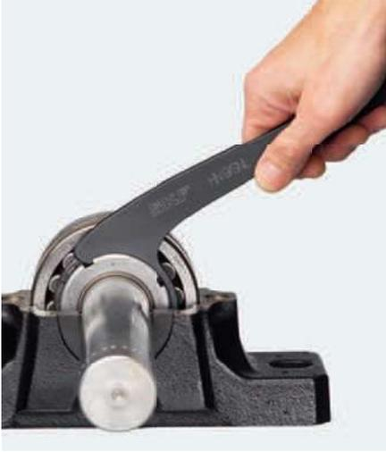
Pour un montage/démontage simple et rapide des roulements dans les paliers SNL
