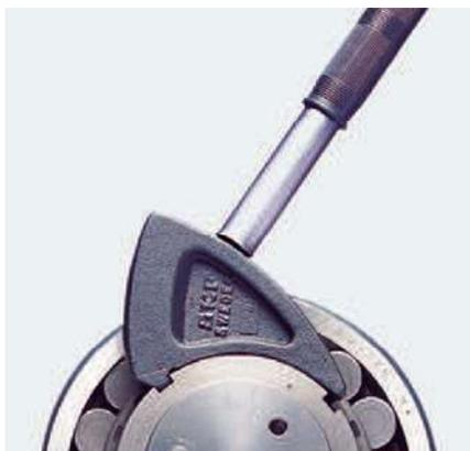
Des forces d'impact élevées sans détérioration de l'écrou
