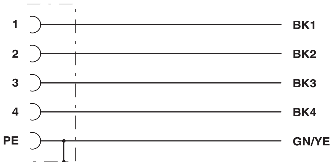
Kontaktbelegung der M12-Buchse
