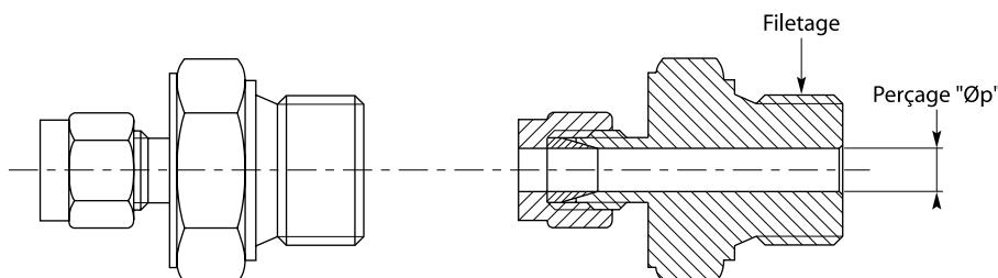
Le raccord coulissant permet un raccordement étanche d'un capteur de température par l'intermédiaire de bagues olives acier inox serties lors du serrage
