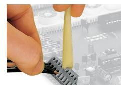
Raccordement des conducteurs, avec outil de manipulation
