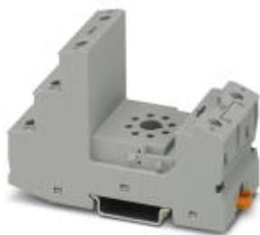
Embase de relais RIF-3, pour relais octaux avec 2 contacts inverseurs, raccordement vissé, enfichabilité pour modules d'entrée/antiparasite, montage sur NS 35/7,5
