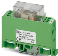
Relaismodul für hohe Dauerströme, mit fest eingelötetem Relais, Kontakte (AgSnO): mittlere bis große Leistungen, 1 Schließer, Eingangsspannung 24 V DC, Grenzdauerstrom 10 A, mit 2 Eingängen für Hand/Automatik
