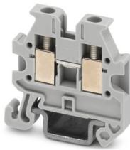
微型直通式接线端子，标称工作电压: 400 V，额定电流: 17.5 A，连接量: 2，位数: 1，接线方式: 螺钉连接，额定接线容量: 1.5 mm<sup>2</sup>，横截面: 0.14 mm<sup>2</sup> - 1.5 mm<sup>2</sup>，安装方式: NS 15，颜色: 灰色
