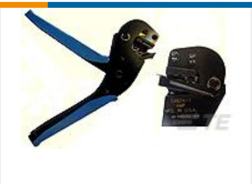
TE 系列/零件编号59824-1 TETRA-CRIMP HT ASSY
