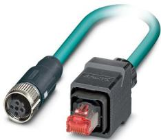
Câble de réseau, Ethernet CAT5 (100 Mbit/s), 4-pôles, Type de câble variable, blindé, connecteur mâle droit RJ45 Push-Pull / IP67, sur connecteur femelle droit M12 SPEEDCONNEC / IP67, détrompage: D, longueur de câble: Longueur au choix (0,2... 40,0 m)
