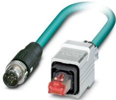
Câble de réseau, Ethernet CAT5 (100 Mbit/s), 4-pôles, blindé, connecteur mâle droit M12 SPEEDCONNEC / IP67, détrompage: D, sur connecteur mâle droit RJ45 Push-Pull / IP67, longueur de câble: 10 m
