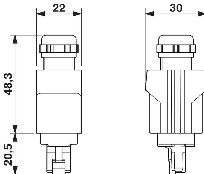
Connecteur mâle RJ45 Push-Pull, IP67
