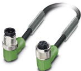
センサ/アクチュエータケーブル, 4-極, PUR ハロゲンフリー, 黒-灰RAL 7021, プラグ アングル M12, Aコーデイング, 上 ソケット アングル M12, Aコーデイング, ケーブル長: 3 m
