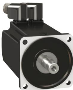
**Servomotor, Lexium BMH, 100mm, 9,0Nm, glatte Welle IP54, Multiturn 16P/U, 2xM23 abgewinkelt**
