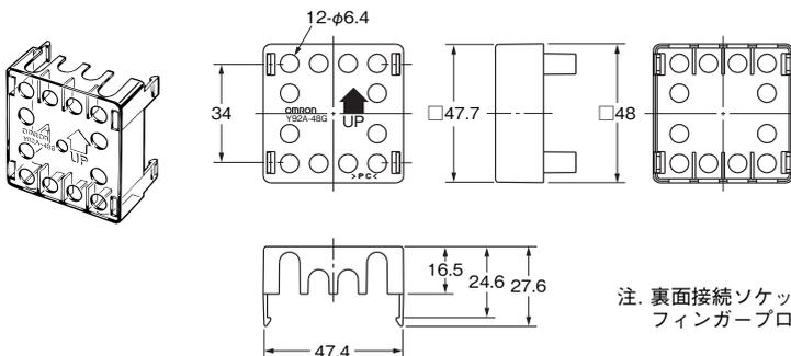
注. 裏面接続ソケット(形 P3GA-11)に取り付けて使用することにより、フィンガープロテクトが可能です。
