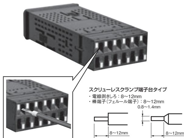
電線：AWG24～AWG18(0.21～0.82mm<sup>2</sup>)のより線か、単線
