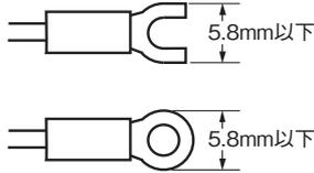
1端子への配線は、絶縁被覆付圧着端子2枚まで接続可能ですが、絶縁被覆径の大きいものはご使用することができません。下の図を参考にして、締め付け可能な圧着端子を選定してください。（形E5CC-Uは除く）
