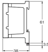
形E5CC-TをDINレールへ取り付けるためのアダプタです。
