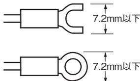
・形E5DCで圧着端子を使用される場合は、絶縁被覆が付いた圧着端子をご使用ください。裸圧着端子をそのままご使用されると、上下端子間が短絡する恐れがあります。裸圧着端子をご使用される場合は、絶縁性能のあるマークチューブで圧着部分をカバーしてください。また、マークチューブがずれないように、マークチューブを固定するなどしてご使用ください。
