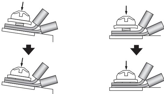
圧着端子によっては圧着部が大きいものがあり、その場合は、図のようにあらかじめ曲げ加工をして、端子ねじと端子台の端子面が垂直になるようにゆっくりと締め付けてください。
