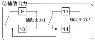
\*異なる電位を補助出力1、2に接続する場合、COM端子の単一故障状態をご確認の上、ご使用ください。
