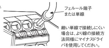
細い単線で接続しにくい場合は、より線の接続方法同様にマイナスドライバを使用してください。
