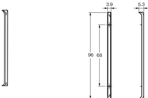
形E5DC/形E5DC-Bを盤面取り付け時に本体とパネルの隙間を隠すためにご利用ください。
