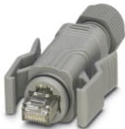
Connecteur RJ45, indice de protection: IP67, nombre de pôles: 8, CAT5 (CEI 11801:2002), matériau: PA, type de raccordement: Raccordement autodénudant IDC, section raccordable: AWG 26- 23, sortie du câble: droite, coloris: noir foncé RAL 9005
