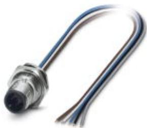
センサ/アクチュエータパネル貫通コネクタ、5極、M12 SPEEDCON、Aコーディング、M16ネジで背面/ネジ取付け、0.5 mのTPEばら線、5 x 0.34 mm<sup>2</sup>
