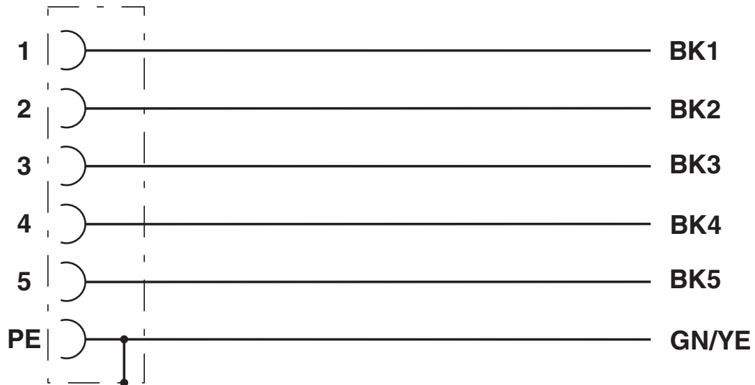
Kontaktbelegung der M12-Buchse
