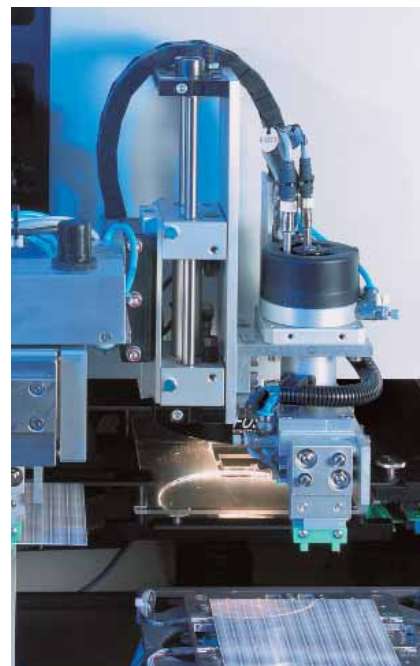
Ajustement au laser d'éléments sensibles en platine, sous forme de puce (chip)
