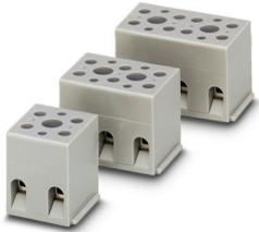
设备接线端子，标称工作电压: 500 V，额定电流: 32 A，连接量: 6，位数: 3，接线方式: 螺钉连接，额定接线容量: 4 mm<sup>2</sup>，横截面: 0.2 mm<sup>2</sup> - 4 mm<sup>2</sup>，安装方式: 直接螺钉连接，颜色: 灰色
