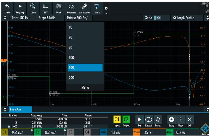
La resolución de la medición se puede variar cambiando los puntos por década
