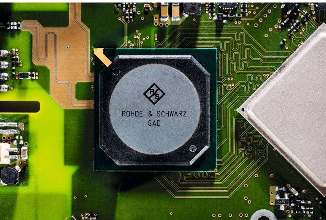
El convertidor A/D de 10 bits diseñado por Rohde&Schwarz garantiza la máxima fidelidad de señal con la máxima resolución.
