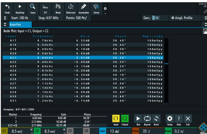
Una tabla de resultados proporciona información detallada sobre cada punto de medición, que consiste en frecuencia, ganancia y desplazamiento de fase.
