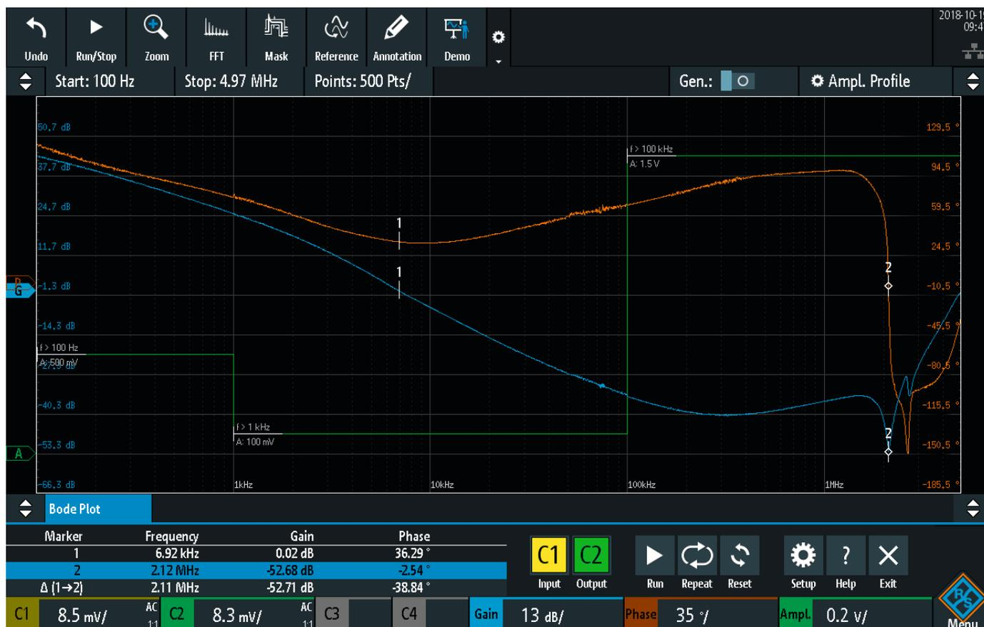
La opción de análisis de respuesta en frecuencia R&S®RTB-K36 (diagrama de Bode) caracteriza la respuesta en frecuencia de una variedad de dispositivos electrónicos, incluyendo filtros pasivos y circuitos de amplificación.
