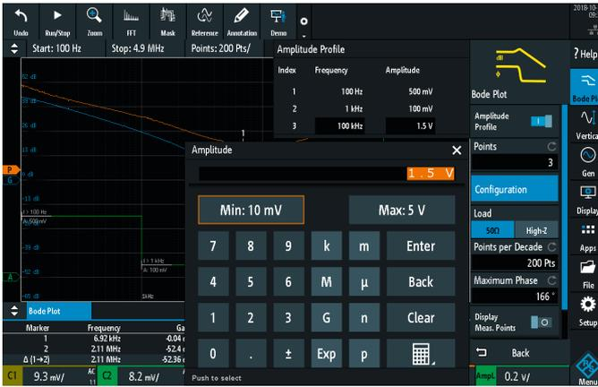
El nivel de salida de amplitud de la señal del generador puede ser variado durante la medición para suprimir el comportamiento de ruido del dispositivo examinado.
