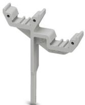
标记槽，卡接到ST 1,5...回拉式弹簧端子，可使用UC-TM 4、UC-TMF 4、UCT-TM 4、UCT-TMF 4、ZB 4或ZBF 4进行标记，灰色，未标记，安装方式：插拔式，文本框高度：10.5 mm，文本框宽度：4 mm
