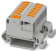
接线板，标称工作电压: 690 V，额定电流: 24 A，连接量: 13，位数: 1，接线方式: 直插式连接，负载触点，额定接线容量: 2.5 mm<sup>2</sup>，横截面: 0.14 mm<sup>2</sup> - 4 mm<sup>2</sup>，线路触点，额定接线容量: 6 mm<sup>2</sup>，横截面: 0.5 mm<sup>2</sup> - 10 mm<sup>2</sup>，安装方式: NS 35/7,5，NS 35/15，颜色: 灰色
