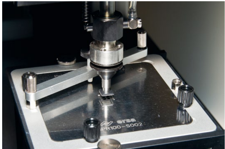
Bauteil ausheben aus Print-Schablone
