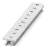
Tira Zack, Tiras, blanco, rotulado, rotulable con: CMS-P1-PLOTTER, rotulación longitudinal: números correlativos de 1 ... 10, 11 ... 20 etc. hasta 491 ... 500, clase de montaje: encajar en ranura para índice alta, para ancho de borne: 6,2 mm, superficie útil: 6,15 x 10,5 mm
