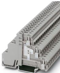
启动器/执行器接线端子，带等电位连接，标称工作电压: 250 V，额定电流: 24 A，接线方式: 螺钉连接，第1, 2和第3层，额定接线容量: 2.5 mm<sup>2</sup>，横截面: 0.2 mm<sup>2</sup> - 4 mm<sup>2</sup>，安装方式: NS 35/7,5, NS 35/15，颜色: 灰色
