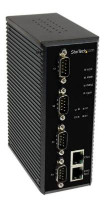
Il convertitore seriale industriale a 4 porte con alimentazione PoE NETRS42348PD permette di gestire da remoto fino a quattro dispositivi seriali RS232/422/485 industriali attraverso la rete LAN/WAN, con alimentatori ridondanti e due porte Ethernet da 10/100 Mbps.
