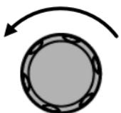
Drehen Sie den Frequenzregler nach links, um die Frequenz zu verringern.
