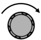
Drehen Sie den Frequenzregler nach rechts, um die Frequenz zu erhöhen.
