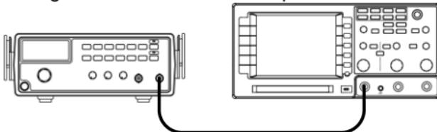
2. Drücken Sie die Ausgangstaste. Der Ausgang wird aktiviert und die LED leuchtet auf.
