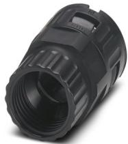
波纹管适配器，带内螺纹，用于将波纹管连接到HEAVYCON EVO M25塑料电缆接头或ADVANCE M25塑料壳体，直头，黑色，IP66。
