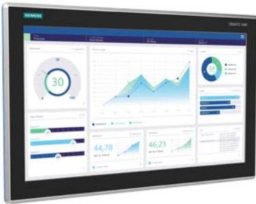
SIMATIC HMI MTP2200 Unified Comfort Panel Hygienic, IP69, Edelstahl, Hygienic Design, 21,5" Widescreen-TFT-Display, 16 Mio Farben, Touchbedienung, blaue FDA-konforme Dichtung, erhöhter Aufprallschutz mit Splitterschutz Displayfront entsprechend Richtlinien DIN EN 1672-2, FDA 21 CFR 177.2006, PROFINET Schnittstelle, projektierbar ab WinCC Unified Comfort V17, enthält Open Source SW, die unentgeltlich überlassen wird siehe beiliegende Blu-Ray
