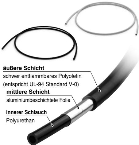
Einsetzbar für allgemeine Druckluft- und Wasserleitungen in Umgebungen, die Schweißspritzern o.Ä. ausgesetzt sind.
