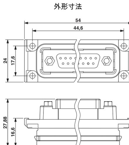
取付け加工図 : VS-09-A...
