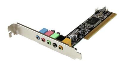
La scheda audio surround PCI PCISOUND5CH2 consente di aggiungere l'audio a 5,1 canali al PC desktop mediante uno slot PCI, offrendo l'uscita audio e l'ingresso microphone/line con mini jack da 3,5 mm.
