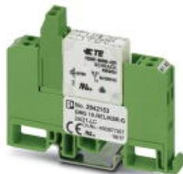
Module porte-relais, avec relais miniature soudé, contact (AgNi) : puissances moyennes à fortes, 1 contact inverseur, tension d'entrée 24 V DC
