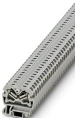
微型直通式接线端子，标称工作电压: 800 V，额定电流: 24 A，连接量: 2，接线方式: 回拉式弹簧连接，第一层，额定接线容量: 2.5 mm<sup>2</sup>，横截面: 0.08 mm<sup>2</sup> - 4 mm<sup>2</sup>，安装方式: NS 15，颜色: 灰色
