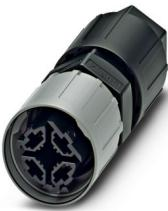
连接器，product family: QPD，接线方式: 快速免剥线，位数: 3+PE，0.5 mm<sup>2</sup> ... 1.5 mm<sup>2</sup>，690 V，17.5 A，PA，黑色，带QUICKON螺母，编码: 防插错编码条，电缆外径: 5 mm ... 7 mm 和 7 mm ... 9.5 mm
