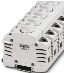
保险丝接线端子，保险丝类型: 螺纹管，保险丝类型: D 02 / E 18，标称工作电压: 400 V，额定电流: 63 A，接线方式: 螺钉连接，额定接线容量: 35 mm<sup>2</sup>，接线容量: 1.5 mm<sup>2</sup>- 35 mm<sup>2</sup>，安装方式: NS 35/7.5, NS 35/15，颜色: 浅灰
