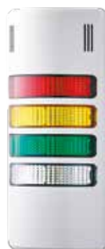
Référence: HD90-Q1039 Couleurs: rouge-jaune-vert-clair Fonction: Feu LED fixe, son pulsatoire ou permanent Couleur du boîtier: gris Tension nominale: 24 V AC/DC
