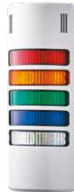
Référence: HD90-Q36 Couleurs: rouge-orange-vert-bleu-clair Fonction: Feu LED fixe, son pulsatoire ou permanent Couleur du boîtier: gris Tension nominale: 24 V AC/DC
