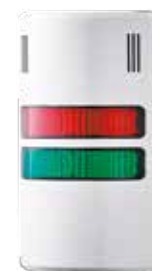
Référence: HD90-Q82 Couleurs: rouge-vert Fonction: Feu LED fixe, son pulsatoire ou permanent Couleur du boîtier: gris Tension nominale: 230-240 V AC
