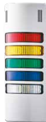
Référence: HD90-Q1036 Couleurs: rouge-jaune-vert-bleu-clair Fonction: Feu LED fixe, son pulsatoire ou permanent Couleur du boîtier: gris Tension nominale: 24 V AC/DC
