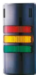
Référence: HD90-Q77 Couleurs: rouge-jaune-vert Fonction: Feu LED fixe Couleur du boîtier: noir Tension nominale: 230-240 V AC
